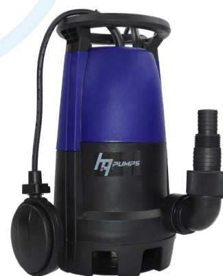
BASE NOIRE pour eaux grises passage libre jusque 30 mm
