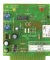
DSN 52 bi-électrode avec détection niveau critique
