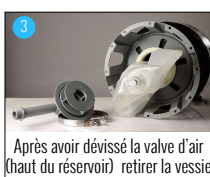
Dévisser l'écrou du collier de serrage afin de retirer ce dernier
