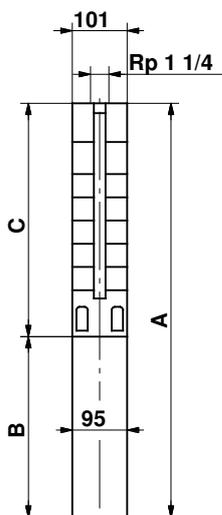
101 mm = Diamètre maxi de la pompe, protège-câble et moteur inclus.
