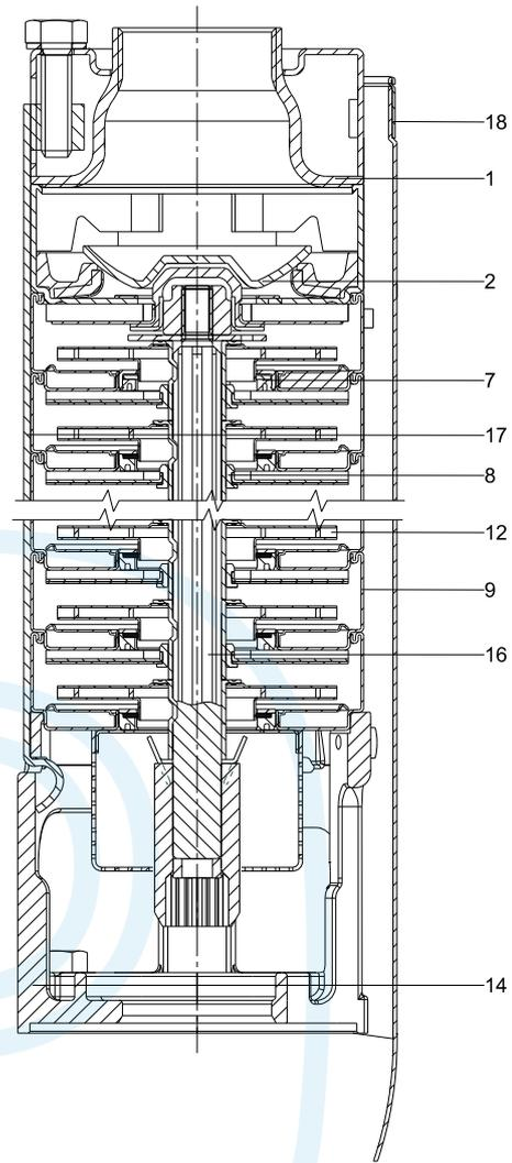
Fig. 8 Exemple SP3A, pompe à arbre cannelé
