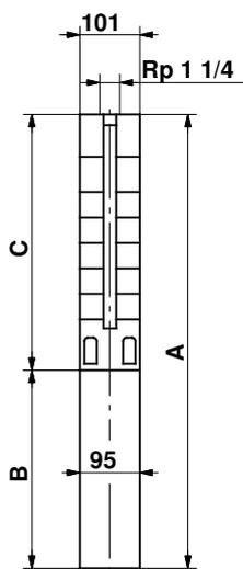
101 mm = Diamètre maxi de la pompe, protégé-câble et moteur inclus.
