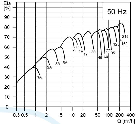
Fig. 1 Rendement pompe/moteur par rapport au débit
