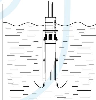
Fig. 33 Rôle de la chemise de refroidissement
