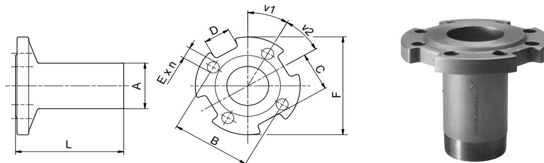
Fig. 29 Schéma coté et photo du raccord filetage-bride
