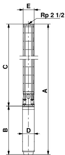
Les pompes SP 17-43 et SP 17-60 sont montées dans le manchon pour raccord R 3.
