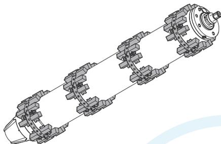
Fig. 31 Moteur immergé équipé d'anodes
