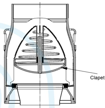
Fig. 5 Clapet anti-retour
