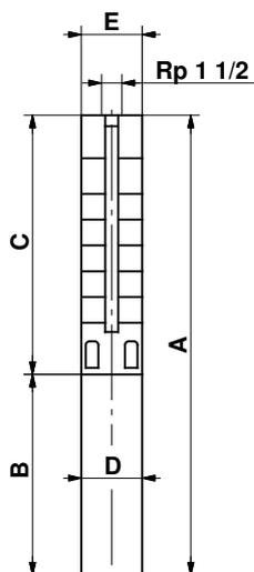
Les pompes SP 5A-75 et SP 5A-85 sont montées dans le manchon pour raccord R 1 1/2.
