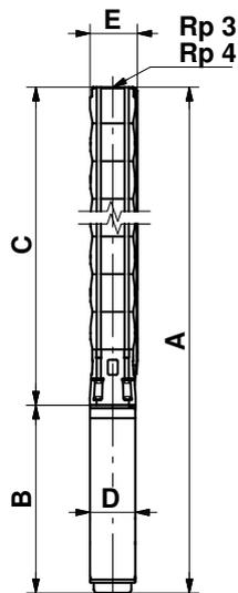
Les pompes SP 60-24 et SP 60-30 sont montées dans le manchon pour raccord R 4.
