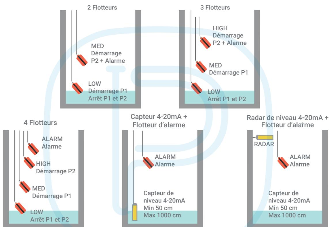
Si vous utilisez un capteur de niveau 4-20 mA, vous pouvez régler la plage de mesure entre 50 cm et 1000 cm selon le modèle de capteur (voir chapitre 3).
