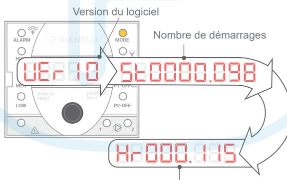
Sélectionnez le texte [dAtA] dans le menu MODE (voir chapitre 3) puis pressez une fois le bouton pour que l'historique commence à défiler. Les données de fonctionnement apparaissent dans l'ordre suivant: Version du logiciel, nombre de démarrages pompe 1, heures de fonctionnement pompe 1, nombre de démarrages pompe 2 et heures de fonctionnement pompe 2.
