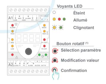
(1) Molette sur encodeur à rotation infinie avec fonction bouton-poussoir.
