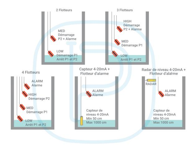
Si vous utilisez un capteur de niveau 4-20 mA, vous pouvez régler la plage de messure entre 50 cm et 1000 cm selon le modèle de capteur (voir chapitre 3).
