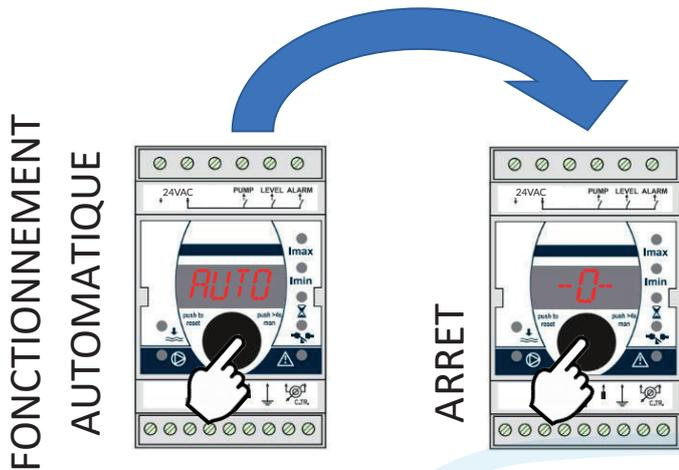
Une pression sur le bouton noir permet le changement du mode automatique au mode arrêt et inversement.
