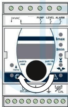
La rotation du bouton permet de basculer d'un paramètre a un autre.
