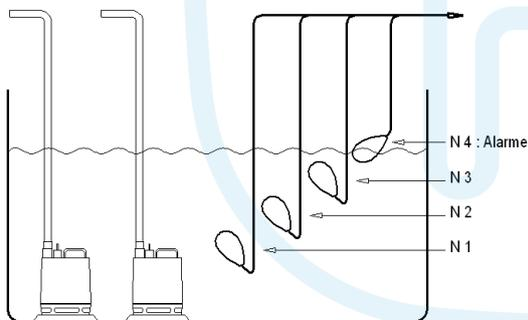
N4 : Activation de la sortie alarme et forçage des pompes (temporisation 10 sec)
