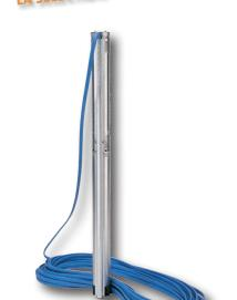
Les pompes SQ sont des pompes immergées 3" conçues pour fonctionner en continu ou en intermittance dans des applications variées. Grâce à leurs dimensions compactes, elles peuvent s'installer dans un forage de diamètre réduit. Les pompes SQ peuvent être également installées horizontalement (chemise de refroidissement recommandée).
