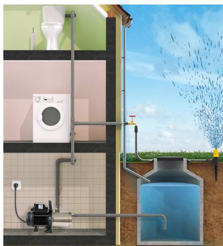
Pompe de surface pour l'arrosage pour irriguer et fournir de la pression à l'installation hydrique domestique. EVOTRONIC 350 est un système composé d'une électropompe horizontale centrifuge multi-étages et d'un système de contrôle électronique (variateur de vitesse) qui permet de maintenir la pression constante dans l'installation, en réduisant ou en augmentant la vitesse de rotation du moteur de l'électropompe en fonction de la demande d'eau.
