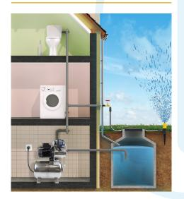
Groupe de surpression entièrement en acier inox, avec système hydraulique multicellulaire nouvelle génération à haut rendement. Le pressostat éléctronique avec manomètre digital intégré DIGIPRESS offre une protection contre la marche à sec et le surcharge moteur; quand le DIGIPRESS est déconnecté par le manque d'eau, il est programmé pour se réenclencher automatiquement jusqu'au rétablissement de l'alimentation en eau.
